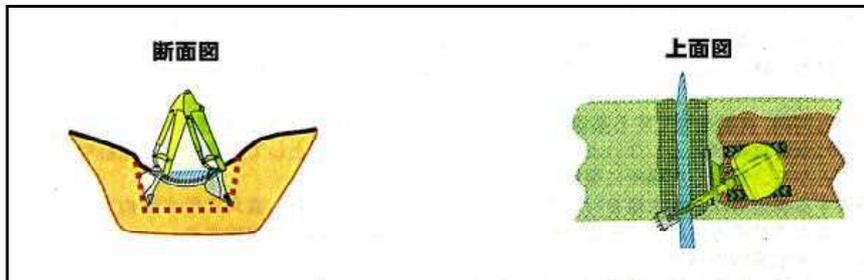
イ 床堀後は、床堀箇所をバケットの底を使って転圧し、基礎部を締め固めする。また、アで保管した転石等も基礎部に敷設できるようであれば利用する。
